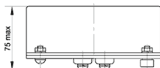
Трансформатор тока ТЗЛМ-1 Масса макс. 2,3 кг.
